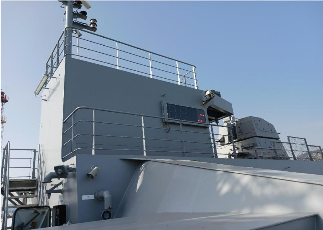
**3. Stations de contrôle en passerelle** : présentes au nombre de 3 en passerelle de navigation des BRP, elles permettent à l'équipage de contrôler les distances de ravitaillement (stations bâbord et tribord) et la configuration des RAM (station principale).
